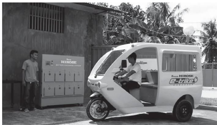
バッテリー交換ステーション
